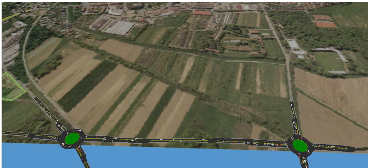
Izsek iz dinamične 3D simulacije za plansko leto 2027- dvopasovna krožna križišča severne obvoznice z Markišavsko in Kopališko ulico (pogled iz smeri »Markišavci«).
