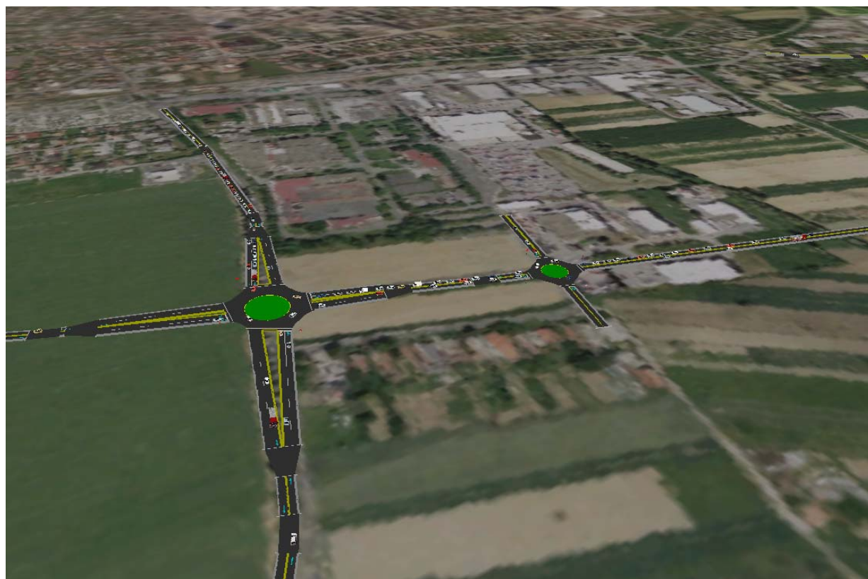
Izsek iz dinamične 3D simulacije za plansko leto 2027- dvopasovno krožno križišče Panonske ulice z vzhodno obvoznico in enopasovno krožno križišče »pri industrijski coni« (pogled iz smeri »Rakičan«).
