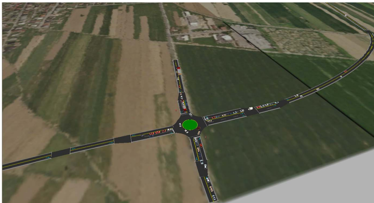
Izsek iz dinamične 3D simulacije za plansko leto 2027- dvopasovno krožno križišče Bakovske ulice z južno obvoznico (pogled iz smeri »AC priključka Murska Sobota«).
