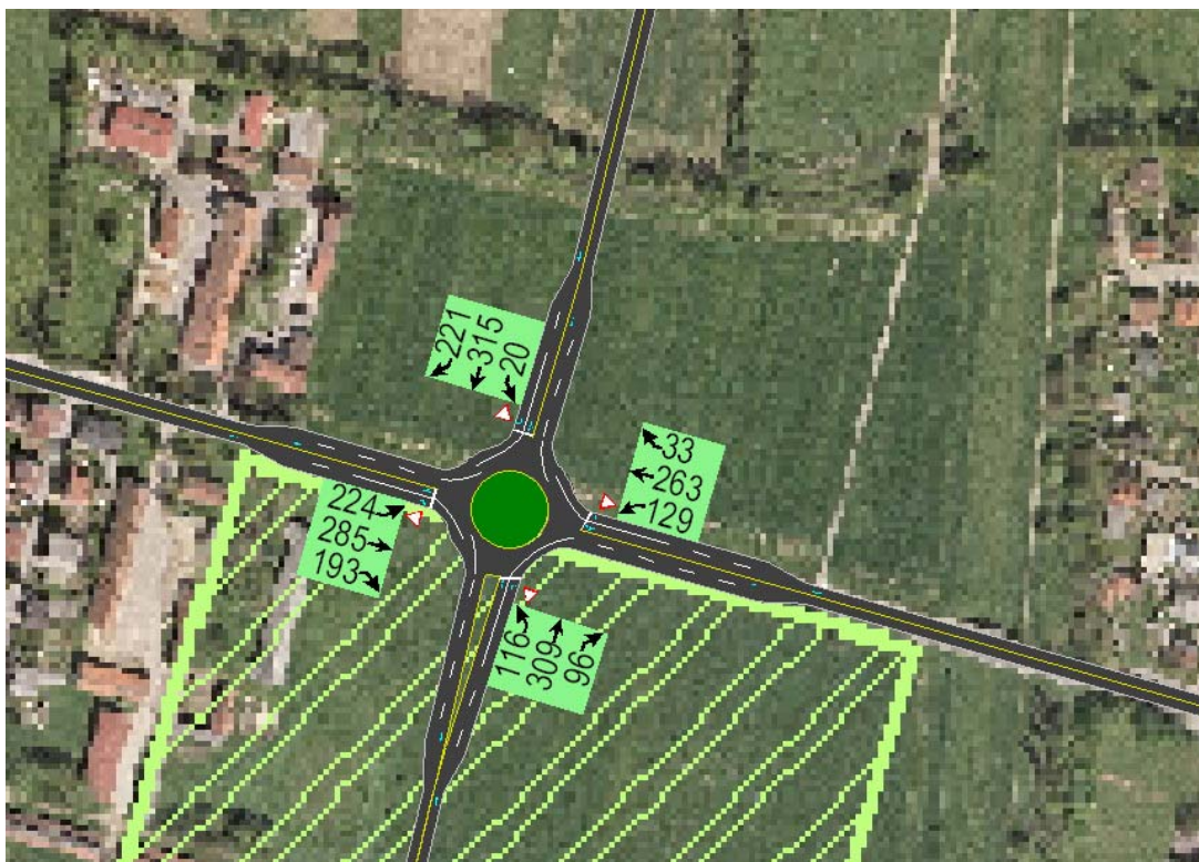
Simulirane prometne obremenitve (znotraj konične ure 2027) v križišču ulice Štefana Kovača in zahodne obvoznice.
