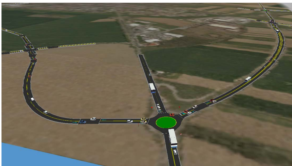
Izsek iz dinamične 3D simulacije za plansko leto 2027- enopasovno krožno križišče Tišinske ulice z južno in zahodno obvoznico (pogled iz smeri »Radenci«).
