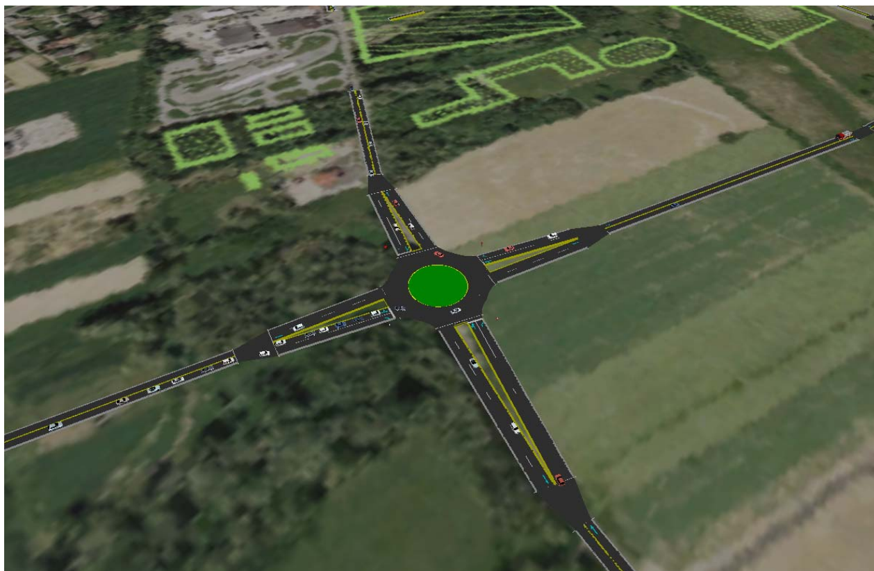
Izsek iz dinamične 3D simulacije za plansko leto 2027- dvopasovno krožno križišče Noršinske ulice z vzhodno obvoznico (pogled iz smeri »Noršinski«).
