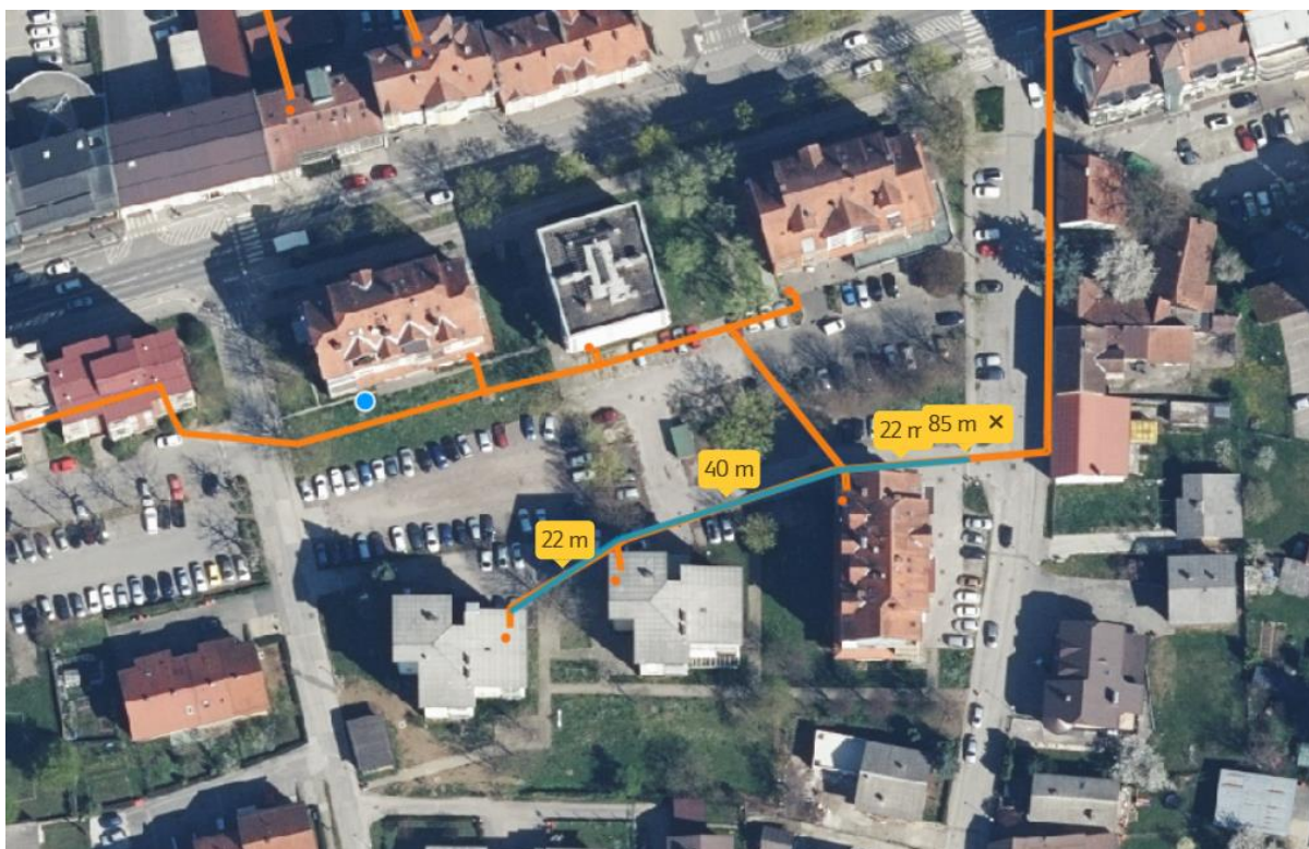
Slika 3: Shema poti menjave obstoječega vročevoda
