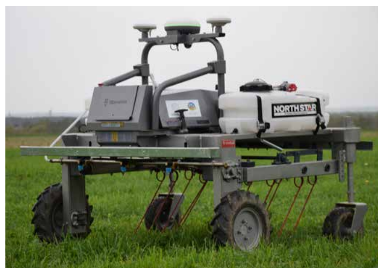
Robot za odstranjevanje plevela v zelenjadarstvu.
