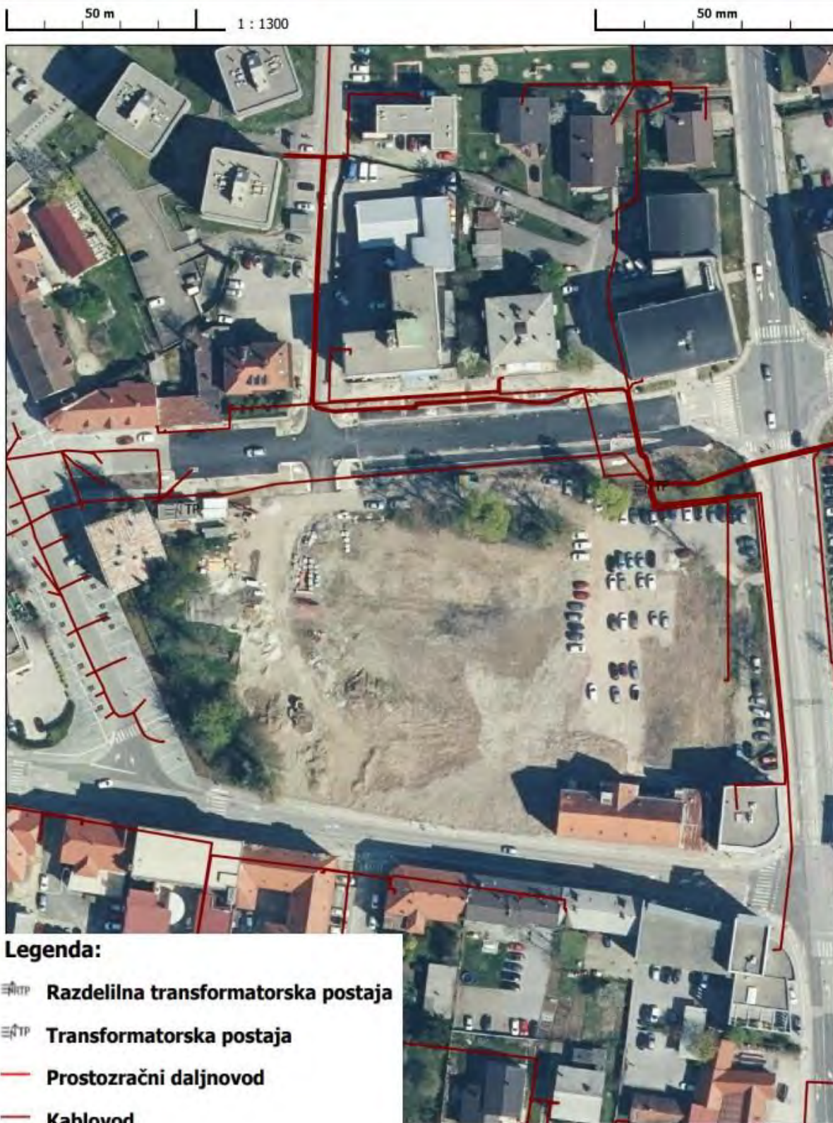
Slika 8: obstoječe elektroenergetsko omrežje, vir: https://gis.iobcina.si , marec 2023
