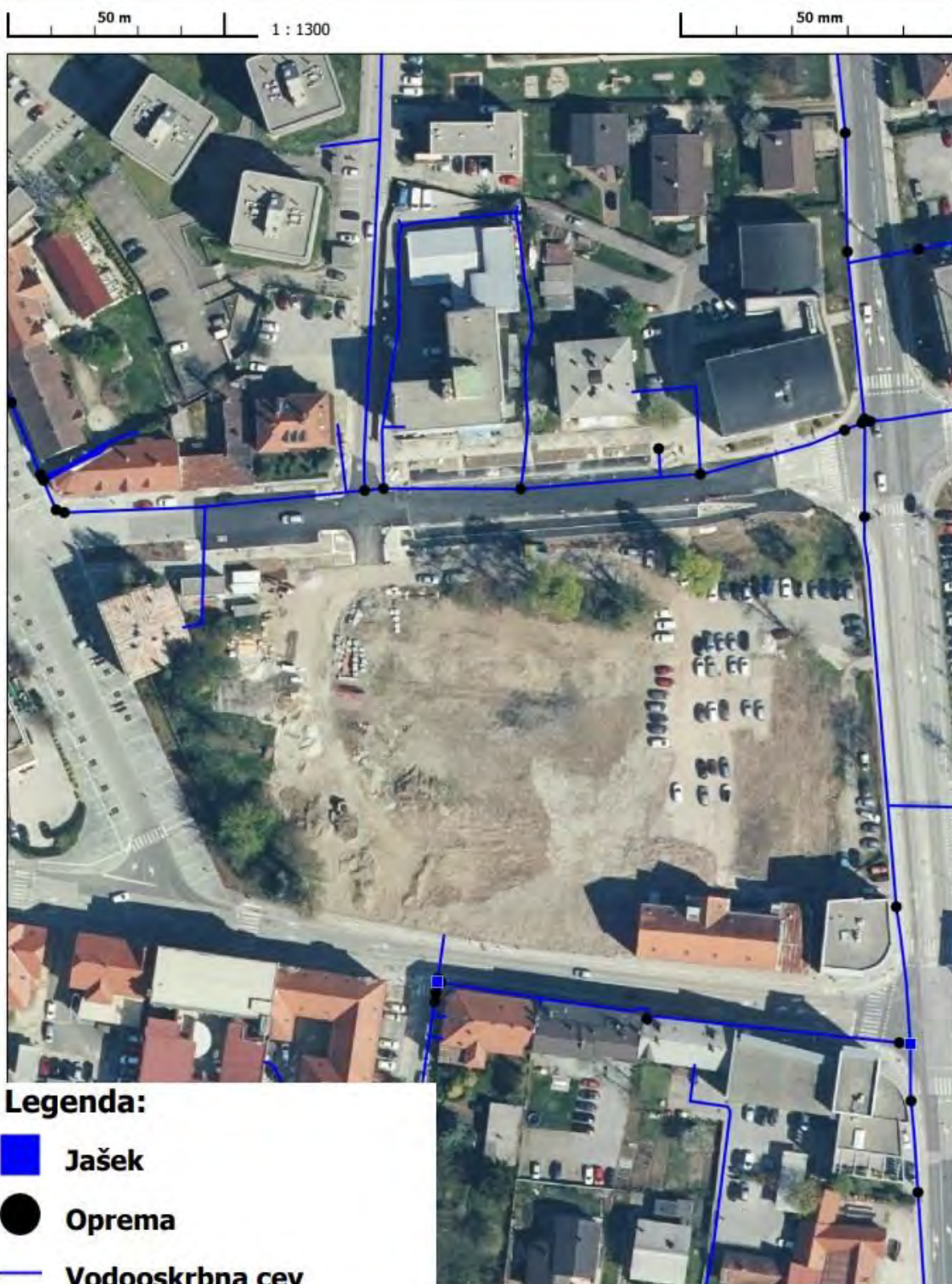
Slika 5: obstoječa vodovodna kanalizacija, vir: https://gis.iobcina.si , marec 2023
