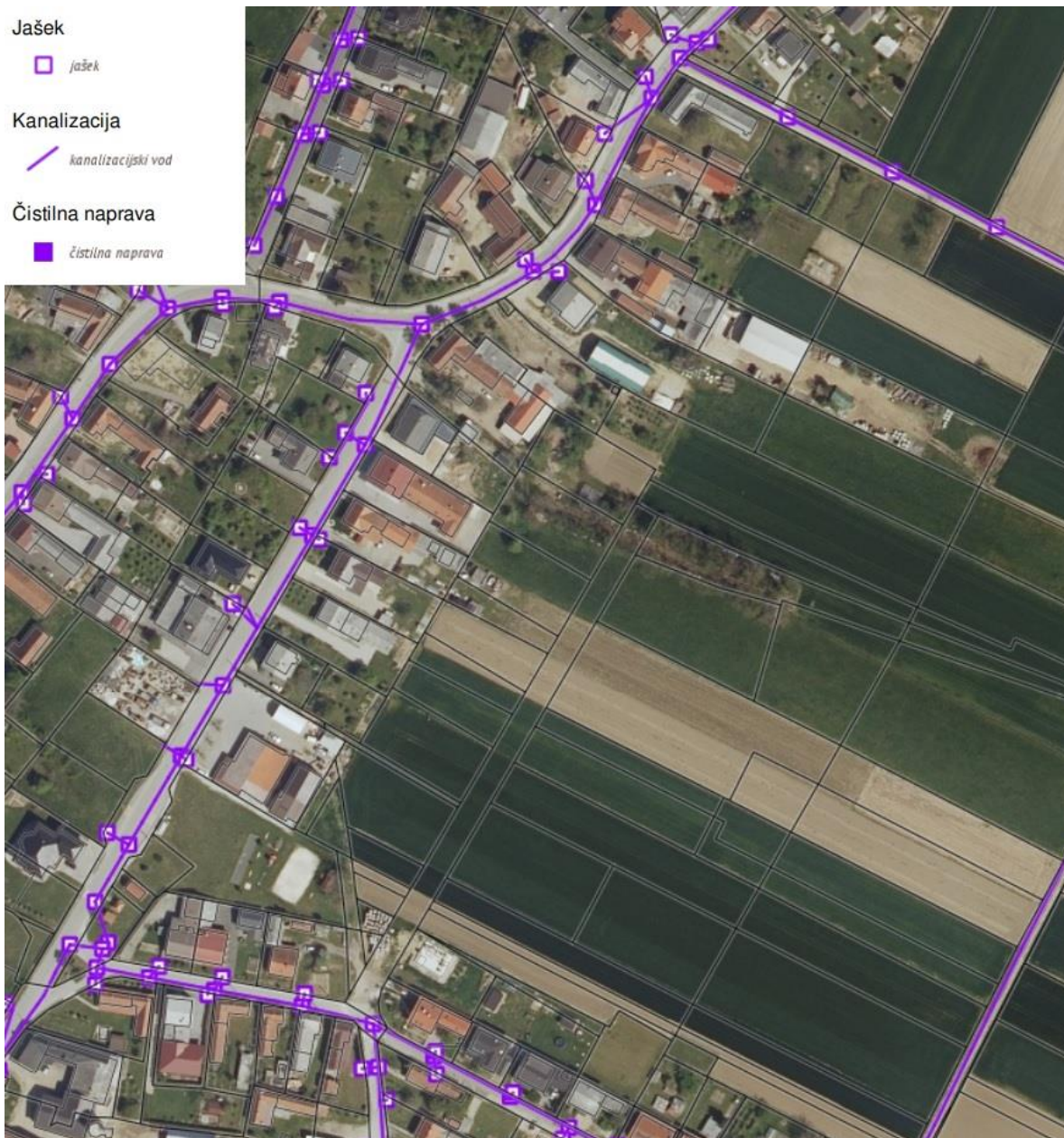
Slika 6: obstoječa fekalna kanalizacija, vir: https://e-terra.si , marec 2022
